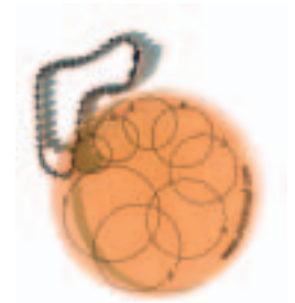
Das Maß aller Knöpfe: mit dieser runden Kunststoffscheibe lässt sich schnell, unkompliziert und doch präzise der Durchmesser eines Knopfes feststellen.
